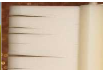
Рис. 3. Расслоение (деламинация) материала
