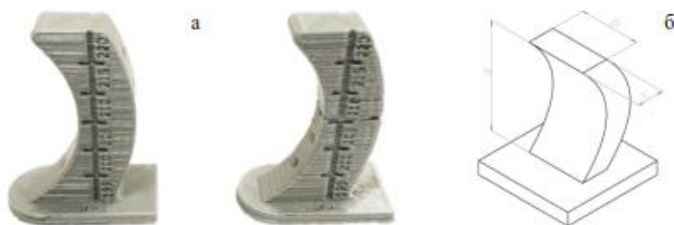
Рис. 1. a – опытные образцы для определения коэффициента термоусадки моделей (толщина нити 0,4 мм и толщина нити 0,8 мм); б – геометрические характеристики, которые контролировались для определения коэффициента термоусадки k_d
