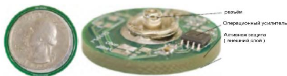
Рис. 6. Изображение бесконтактного емкостного электрода. Печатная плата, содержащая усилительные схемы сверху и чувствительная пластина внизу
