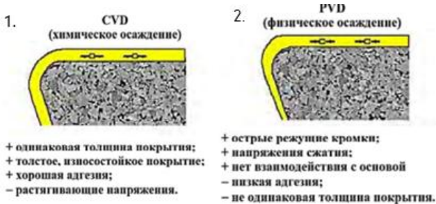
Рис. 3. Сравнение методов CVD и PVD:
