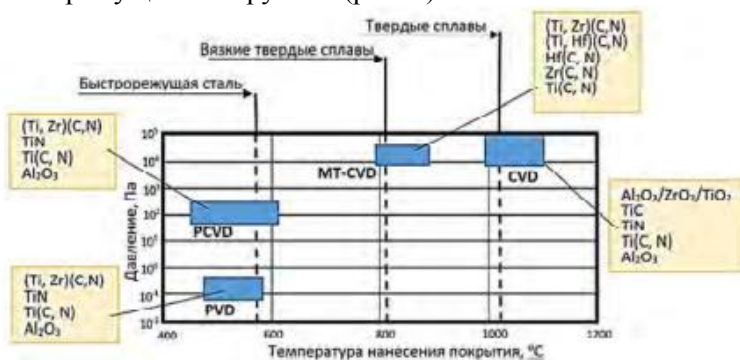
Рис. 1. Параметры основных методов нанесения покрытий на режущий инструмент
