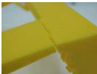
Рис. 2. Трещины и разрушение (деламинация) материала
