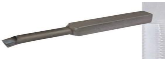
Рис. 2. Расточной упорный резец
