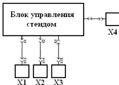
Рис. 5. Схема электрических соединений блока управления станда
