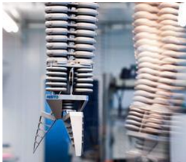
Рис. 2. Манипулятор с максимальным количеством звеньев
