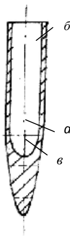
Рис. 2. Оболочка: а – цельная заостренная головная часть; б – полая хвостовая часть; в – вершинный участок головной части
