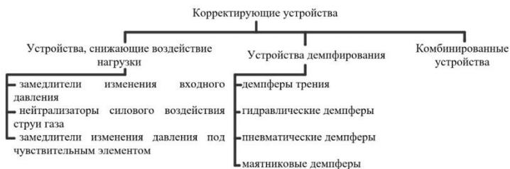
Рис. 1. Классификационная схема корректирующих устройств, улучшающих динамические характеристики ГРД
