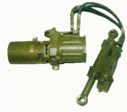
Рис. 1. Гидропривод ВН серийного танкового стабилизатора 2Э42
