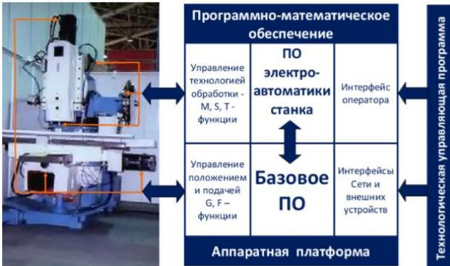
Рис. 1. Функциональная схема системы ЧПУ FMS H400
