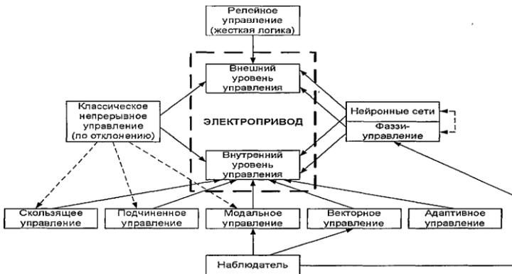
Рис. 1.1. Способы управления электроприводом.
