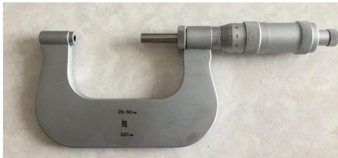
Рис 1. Фото микрометра
