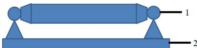
Рис. 1. Схема закрепления испытуемого цилиндра при механических испытаниях: 1 – гидроцилиндр; 2 – приспособление
