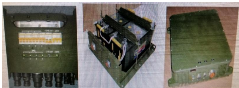
Рис. 3. Щит электропитания, блок аккумуляторных батарей, блок датчиков угла
