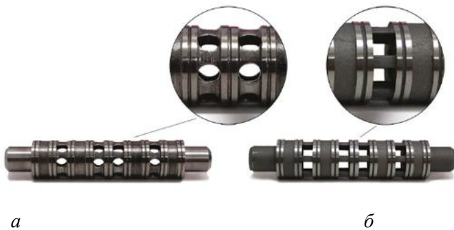
Рис. 2. Золотник гидрораспределителя выполнен: а – по традиционной технологии; б – с помощью SLM технологии
