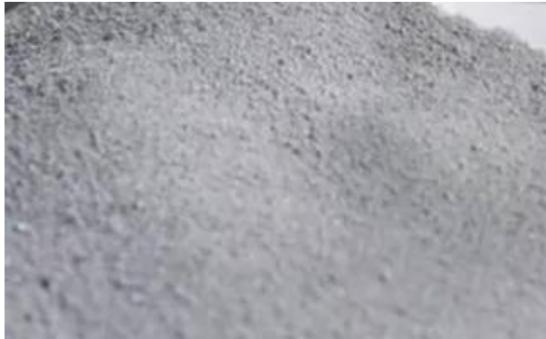
Рис. 1. Нержавеющая сталь 15-5PH в виде порошка для аддитивного производства
