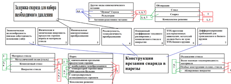
Рис. 5. Функциональная модель явления выстрела с элементами влияния на повышенную эрозию ствола
