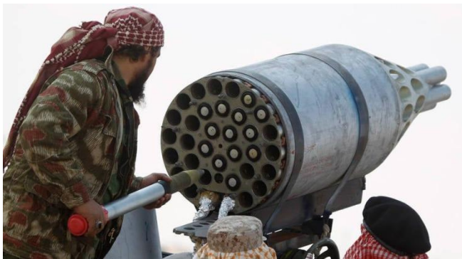
Рис. 3. Кустарное решение на основе Ub-32
