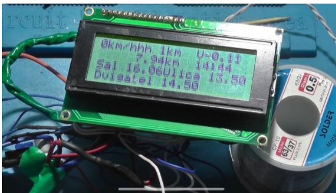
Рис. 8. Результаты работы HUD системы, собранной на процессоре Arduino Uno
