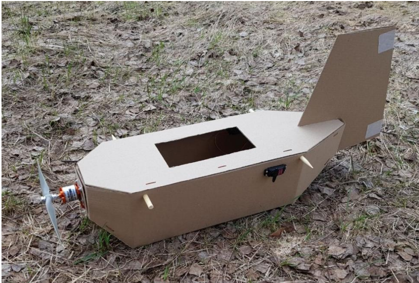
Рис. 5. Фюзеляж с двигателем D3542-1250KV и пропеллером 12x6. Сервоприводы MG 996R. Исполнение "L". Размах крыльев 2000 мм
