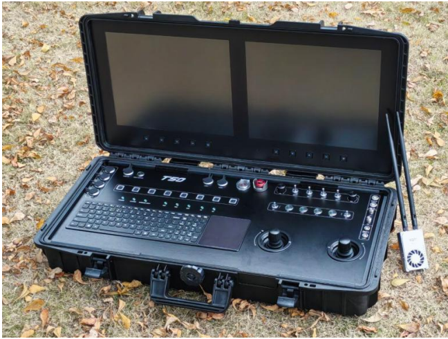
Рис. 4. Наземный пульт управления T50
