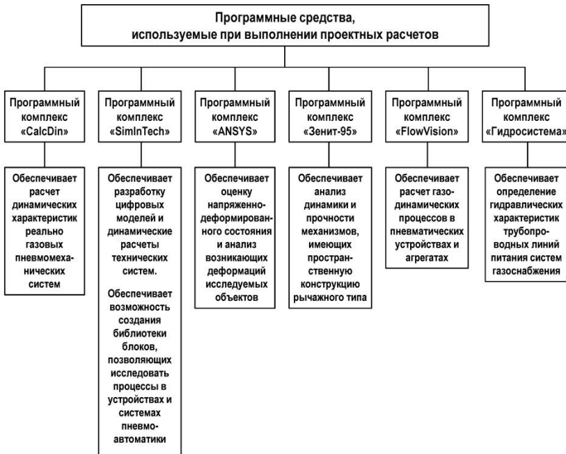
Рис. 2. Программные средства, используемые при выполнении проектных расчетов в КБ «Арматура»
