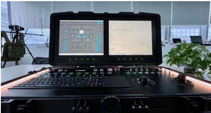
Рис. 5. Иллюстрация работы наземного пункта управления T50
