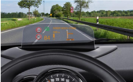
Рис. 4. Проектор с дополнительным сферическим комбайнером
