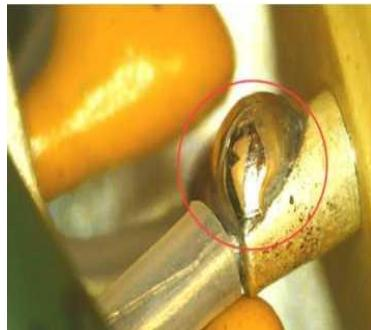
Рис. 4. Излишек припоя в зоне пайки
