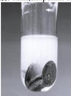
Рис.2. Растворение металлических кнопок в соляной кислоте
