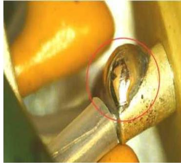
Рис. 4. Излишек припоя в зоне пайки
