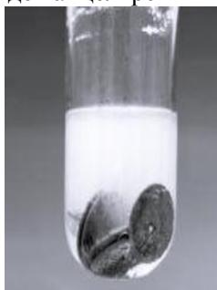
Рис.2. Растворение металлических кнопок в соляной кислоте
