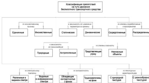
Рис. 2. Классификация препятствий, возникающих на пути движения наземного беспилотного транспортного средства
