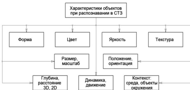
Рис. 3. Характеристики объектов при распознавании в системах технического зрения
