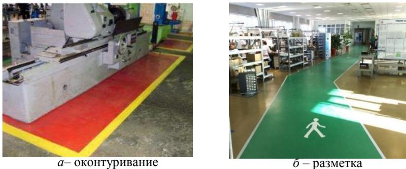
Рис. 4. Приёмы визуализации (оконтуривание (*а*) и разметка (*б*)), используемые ПАО «КМЗ»
