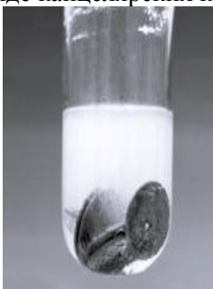
Рис.2. Растворение металлических кнопок в соляной кислоте
