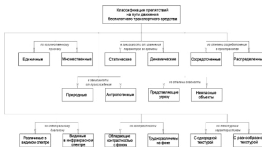
Рис. 2. Классификация препятствий, возникающих на пути движения наземного беспилотного транспортного средства
